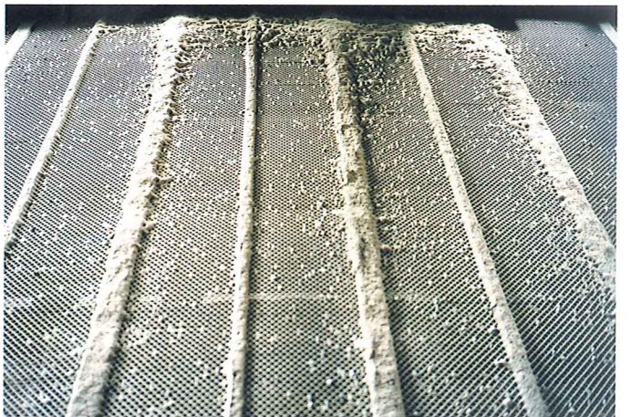
⑥ 投入口の停止後の写真 7×16'用 3%目
