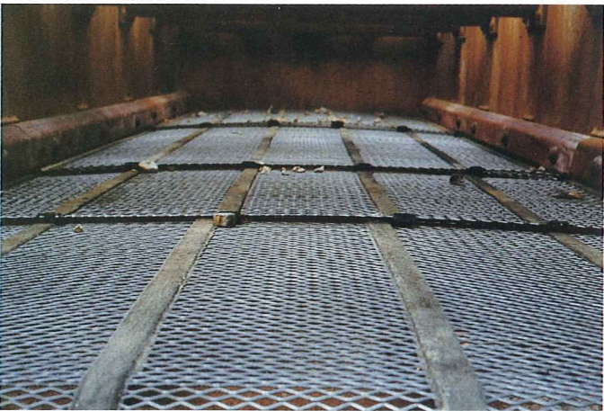
③ 乾式スクリーンパーフェクトスクリーン全面取付写真 5×14'用 (かさね代投入方向へ)
